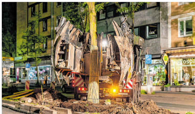
Der Greifer wurde genutzt, um die Bäume sowohl aus- als auch wieder einzugraben. Er schließt sich um die Wurzelballen, damit sie unversehrt bleiben.
